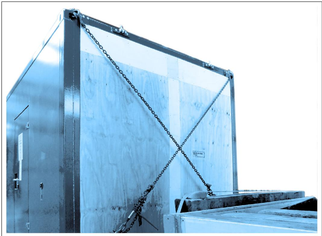
4262384267: Befestigung eines Containers zum Transport auf einem Tieflader
