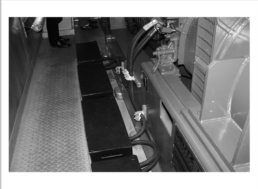
67242-001 Beispiel korrekte Kabelverlegung
