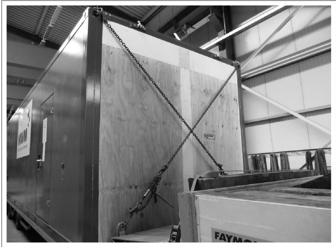
67283-001 Befestigung eines Containers zum Transport auf einem Tieflader
