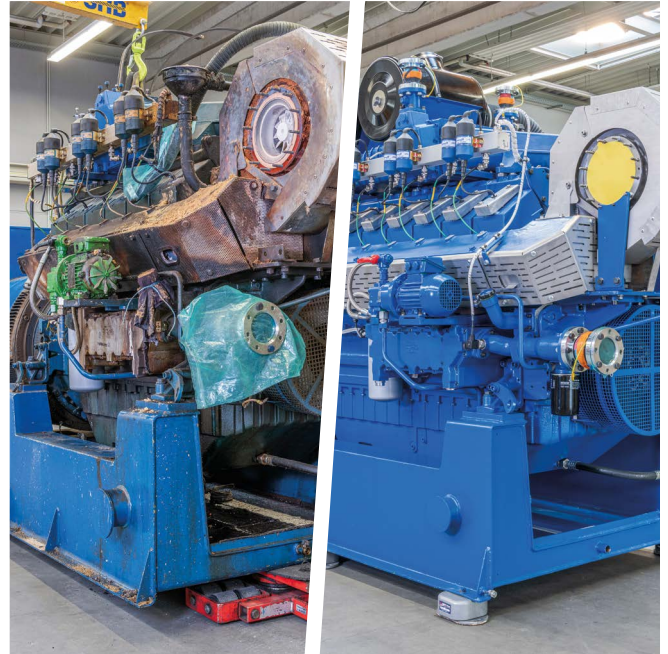
Nach 3-4 Tagen ist das MWM X-Change Aggregat (technisch auf dem neuesten Stand und frisch lackiert) einsatzbereit
