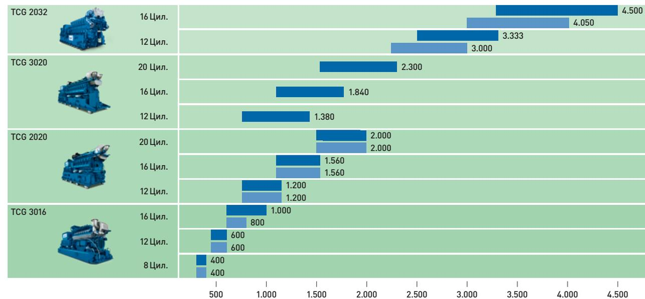
Газопоршневые установки MWM обеспечивают диапазон мощности от 400 до 4500 кВт<sub>эл</sub> для строительства электростанций мощностью 100 000 кВт<sub>эл</sub> и более.
