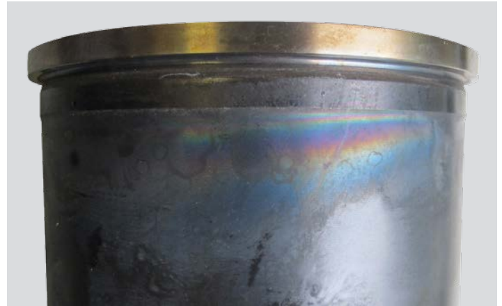
Zylinderlaufbuchse TCG 2016 nach 10.000 Bh mit MWM Premium Antifreeze -20
