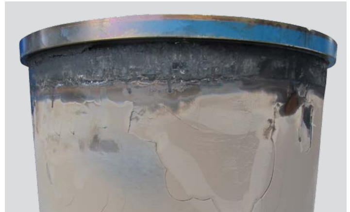
Zylinderlaufbuchse TCG 2016 nach 8000 Bh mit starker Ablagerungsbildung aufgrund einer Inhibitor-Fehldosierung
