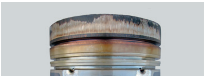
Sondergasanwendung nach > 10.000 Bh mit GMO 240
