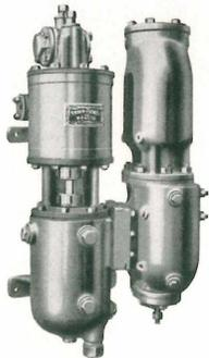
Speisepumpe 250 l/min, Bauart Knorr
