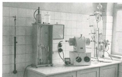
Trocken- und Glühöfen. – Apparat für potentiometrische und elektrolytische Bestimmungen (Analysen)
