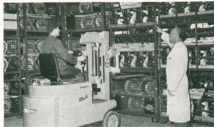
HEUTE: Größte Ausnutzung des Lagerraumes und übersichtliche Lagerhaltung durch das Palettensystem, da Paletten als Zählereinheit dienen
