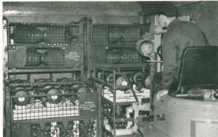
HEUTE: Beladen eines Waggons mit palettierten Bremsausrüstungen durch Gabelstapler
