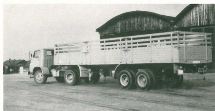
Bei lastunabhängiger Schnellbremsung aus ca. 60 km/h knickte der Zug ein. Hier blieb der Sattelzug bei demselben Versuch, allerdings bei lastabhängiger Bremsung, vollkommen gestreckt
