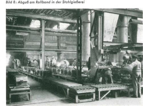
Bild 8: Abguß am Rollband in der Stahlgießerei
