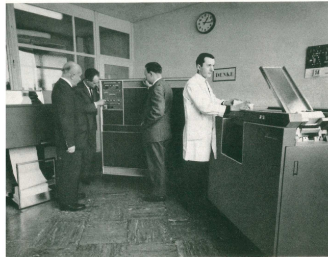
Elektronische Datenverarbeitungsanlage IBM 1401 ohne Magnetbänder, von l. n. r.: Eingabegerät, Zentraleinheit, Ausgabegerät (Drucker)
