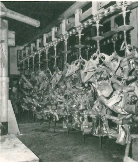
Ausgehängter Rohguß vor dem Putzen
