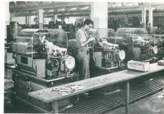
Arbeit an den Index-Automaten. Hier entstehen Kleinteile für Dieselmotoren und die Autobremse
