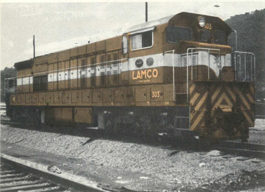
Eine der schweren Loks von Nimba – in Kassel gebaut, mit unserer KE-Bremse ausgerüstet
