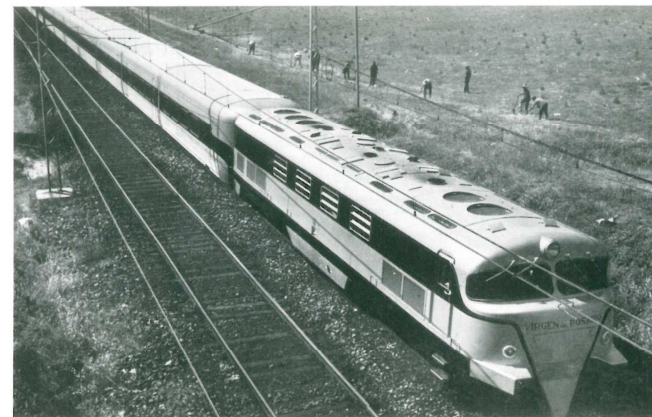
Einer der spanischen TALGO-Luxuszüge, die auf Fernstrecken eingesetzt wurden und hauptsächlich dem Touristenverkehr dienen. Sie sind vollklimatisiert, fahren 140 km/h und werden KE-gelbremst
