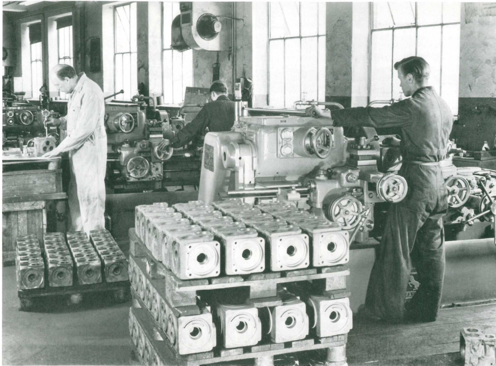
Mechanische Bearbeitung von KE-Ventilgehäusen
