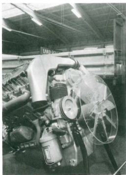
Knorr-1-Zylinder-Luftpressor, luft- gekühlt, 300 ccm Hubraum, mit Antrieb für die Hydraulikpumpe (Baureihe LP 1.904) am neuen MAN- Motor 2658/12 mit den Leistungs- daten: Hubraum 15 l, n = max. 2100, PS 250, Drehmoment 93 m/kp bei n = 1400.
