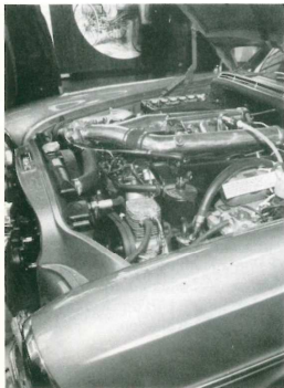
Einblick in den Motorraum des neuen Mercedes 300 SEL 6,3, der in seinem V8-Einspritzmotor 250 PS verbirgt. Die Luftfederungsanlage wird von dem zuverlässigen Knorr- Luftpressor LP 1102 gespeist.
