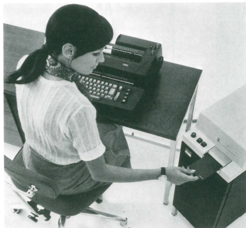
Der Magnetkartenschreiber besteht aus zwei Teilen: einer elektrischen Schreibmaschine und einer Steuereinheit. Foto: IBM
