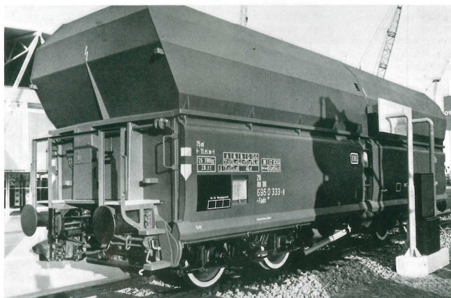
Fad-Selbstentladewagen der Waggon-Union mit automatischer Mittelpufferkupplung UIC
