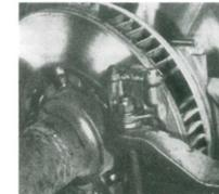
Raffinessen vor. Die überdimensionalen Scheibenbremsen allerdings, die zur Hitzeableitung durch Lamellen von innen belüftet werden, sind für die Eisenbahn ein alter Hut (s. Foto). Schon in den dreißiger Jahren wurden nämlich die ersten Scheibenbremsen in Triebwagen eingebaut. Seit 1987 rüstet man bei der Bundesbahn Reisezugwagen nur noch mit Scheibenbremsen aus.
