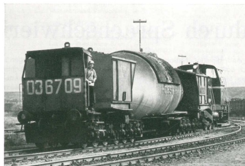
Lok mit Roheisenwagen und Bremserstand. Der Rangierer auf unserem Bild läßt mit Hilfe eines tragbaren Senders die Wagen fahren und bremsen
