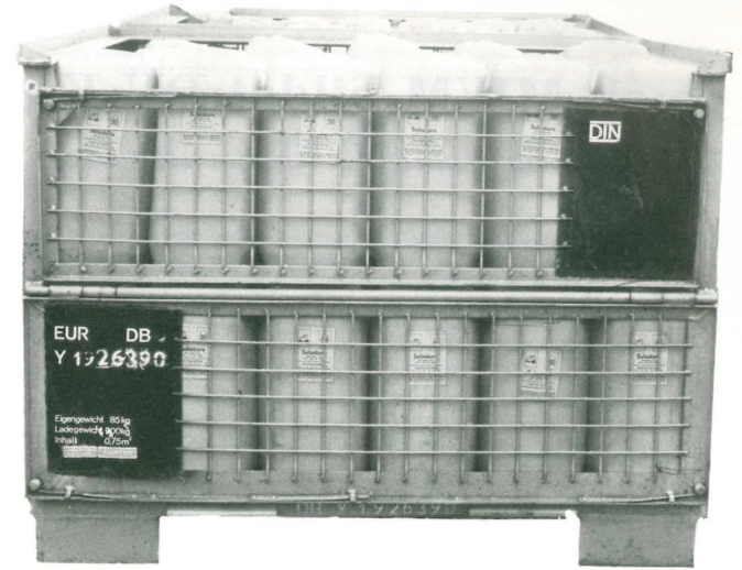
Transport von Salzsäure: Hier wurde ein großer Behälter mit kleineren bestückt
