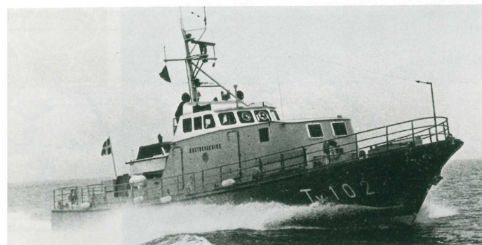
schwedischer Zollkreuzer „Tv 102“, Ausrüstung: 2 x TBRHS 518 V 16-MWM-Dieselmotoren, je 750 PS bei 1800 U/min. Lieferung
