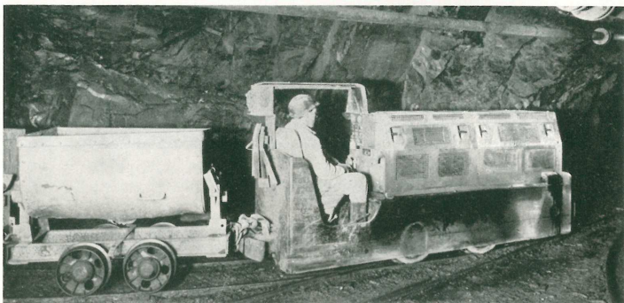
Im Bergwerk: Ruhrthaler Grubenlok mit MWM-Antriebsmotor AKD 1105 Z
