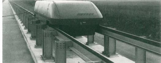
2. Komponentenmeßträger KOMET: Unbemanntes, magnetisch getragenes und geführtes Fahrzeug, ausgestattet mit Aufnahmevorrichtung für den Einbau von Magneten, Linearmotoren und Stromabnehmern verschiedener Bauart, die bei Geschwindigkeiten bis 400 km/h im Zusammenwirken mit ebenfalls leicht auswechselbaren Meßschiene erprobt werden können; der KOMET wird durch einen Schubschlitten mit Heißwasser-Triebwerken beschleunigt.
