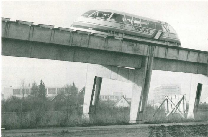
1. Transrapid 04: Personentragendes Magnetschwebe-Versuchsfahrzeug mit Linearmotorantrieb; Magnete des kombinierten Trag- und Führsystems.
