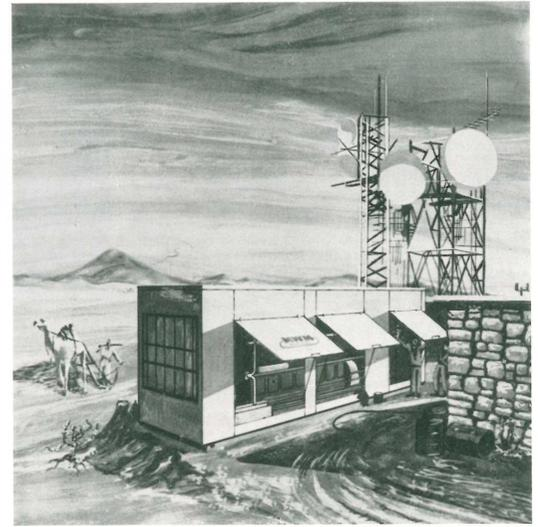
Wo dieselektrische Antriebsaggregate gebraucht werden, kommt es immer auf sofortige Einsatzbereitschaft an. Ortsfeste Anlagen bedingen verhältnismäßig lange Montage- und Aufstellzeiten, ortsbewegliche Aggregate hingegen weniger. Man kennt sie zumeist — wenn schon kompakt — als Anhänger einer Zugmaschine.
