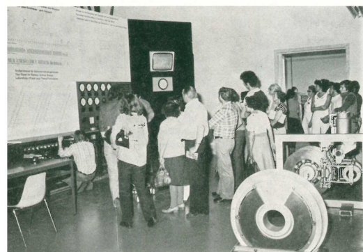
Simulation einer Güterzug-Versuchsfahrt durch den Schwarzwald auf dem Großprüfstand für Schienenfahrzeuge mit eingespieltem Videofilm
