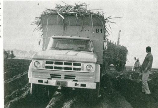
Ein von Chrysler do Brasil gefertigter Lastwagen des Modells „Dodge D-950“ mit 12,7 t Gesamtgewicht bei der Zuckerröhrente
