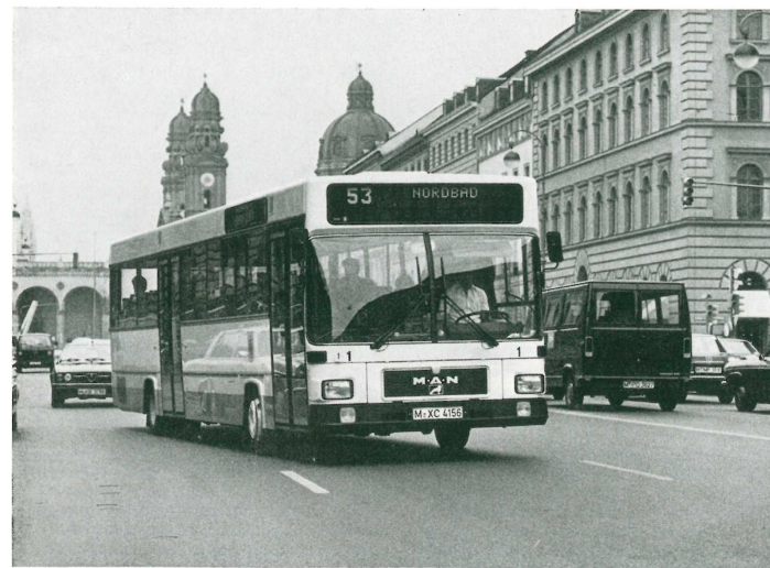
M.A.N.-Standard-Linienbus S 80. Die Weiterentwicklung des bewährten M.A.N.-Stadtbusses nach den Richtlinien des VOV für den Stadtbus der 80er Jahre. Das Projekt S 80 wird vom BMT gefördert. Mit 10 M.A.N.-S 80 wird zur Zeit eine Erprobung in Düsseldorf, München und Trier durchgeführt. Die dabei gesammelten Erfahrungen fließen in das endgültige S 80-Konzept ein. Fahrzeuglänge 11,35 m. Fahrgastkapazität ca. 100 Personen. 177 kW (240 PS)
