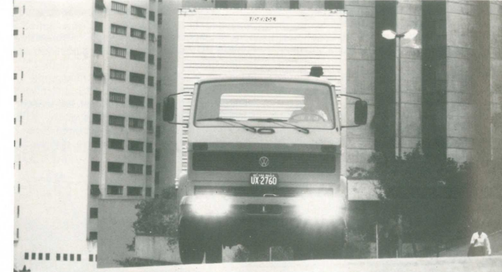
2 LKWs VW 11-130 mit MWM-Motor D 229 - 6 Zylinder, der 132 PS Leistung bei 3000 Umdrehungen bringt
