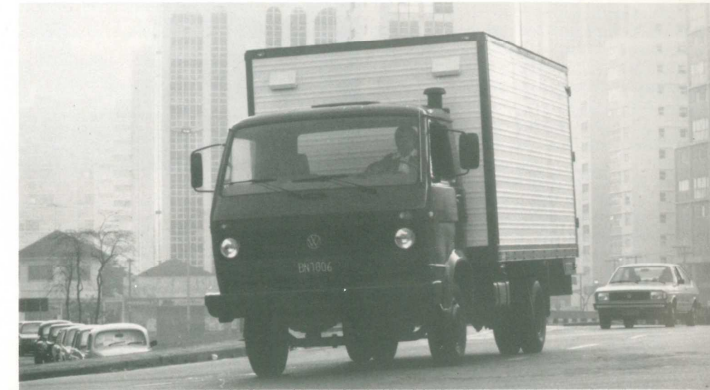
LKW VW 6-90 fährt mit MWM-Motor D 229 - 4 Zylinder. Er leistet 91 PS bei 3000 Umdrehungen
