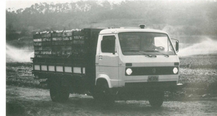
2 LKWs VW 11-130 mit MWM-Motor D 229 - 6 Zylinder, der 132 PS Leistung bei 3000 Umdrehungen bringt
