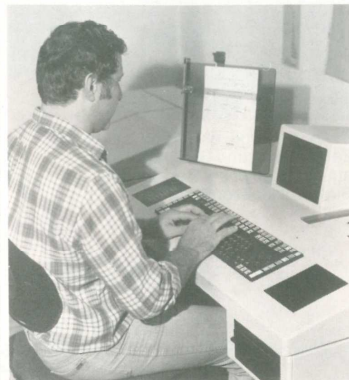
„Linotronic“. Moderne Fotosatzmaschine mit universellen Möglichkeiten. Produkt ist Text als direkt montierbarer Offsetfilm. Sie liefert seit Herbst '82 den WIR-Satz
