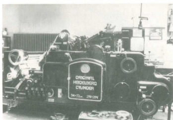
„Original Heidelberg Cylinder“. Buchdruckmaschine, mit der die Werkzeitschrift bis zur Ausgabe 176/1982 hergestellt wurde
