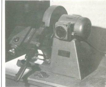
Bleisägemaschine. Im Offsetbereich entsprechen hier Schere und Klinge (für Filmschnitte)
