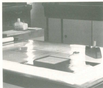
Auf dem Lichttisch werden die Reproduktionsfilme von Fotos und Zeichnungen sowie die Textfilme standgerecht auf eine Trägerfolie geklebt. Mit dem Negativfilm solcher Montage wird dann die fotoempfindliche Schicht der druckenden Offsetplatte im Kontaktverfahren belichtet
