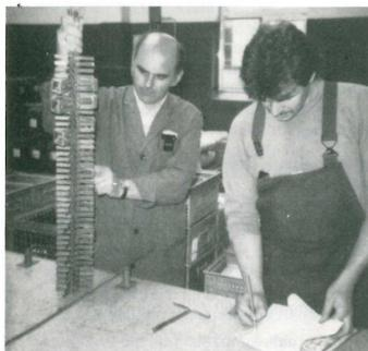
Meister Stock, links, und Galvaniseur Trog bei der Festlegung der optimalen Spannstelle eines Teils
