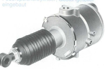
Werkfoto DUEWAG Bremszylinder mit aufgesatteltem Federspeicherzylinder, Gestängesteller eingebaut
