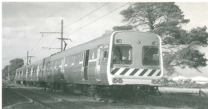
Comeng-Zug für den Melbourne-Nahverkehr; Leichtbauweise aus rostfreiem Stahl – und künftig mit Knorr-Bremsausrüstung
