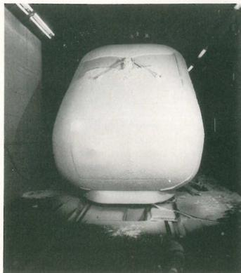
Ein „Geschwindigkeitsrekord“ hat der Inercity Experimental, kurz ICE, auf dem Rollprüfstand der Bundesbahn in München aufgestellt: Ohne sich von der Stelle zu bewegen, erreichte er mühelos 385 km/h. In Wien mußte sich der ICE zweier Teststreifen in der Klimakammer unterziehen.
