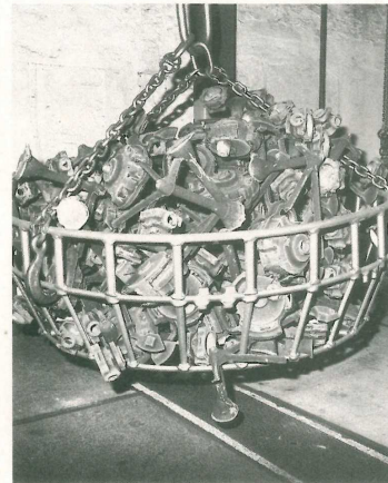
Ungeputzte Gußstücke vor dem Einfahren in die Strahlkabine
